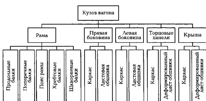
Рис. 10.11. Схема сборки и сварки кузова вагона метрополитена по укрупненным узлам
