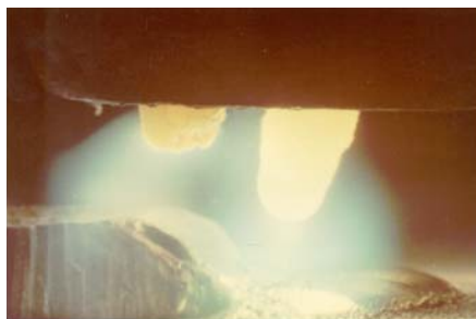
Рис. 4.9. Характерное расположение электродов в трехфазной горелке
