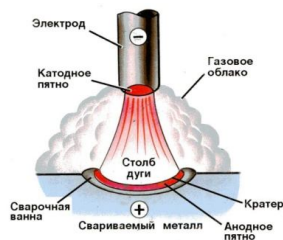
Рисунок 3.3 – Схема горения сварочной дуги
