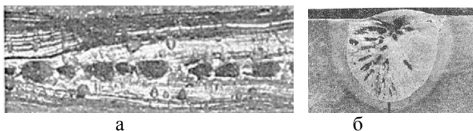
Рисунок 10.20 – Поры в металле шва:
