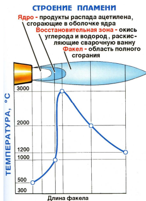
Рисунок 8.3 – Строение газового пламени
