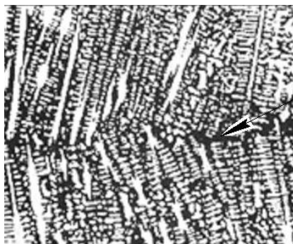
Рисунок 7.4 – Макроструктура центра шва (x200) в зоне срастания кристаллитов передними гранями (в правой части – горячая трещина)
