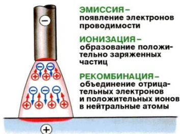
Рисунок 3.1 – Схема ионизации дугового промежутка
