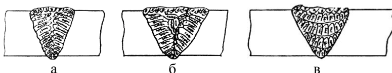
Рисунок 6.13 – Кристаллическое строение сварных швов в поперечном сечении:
