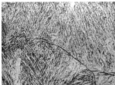
Рисунок 10.16 – Структура металла околошовной зоны, участок перегрева
