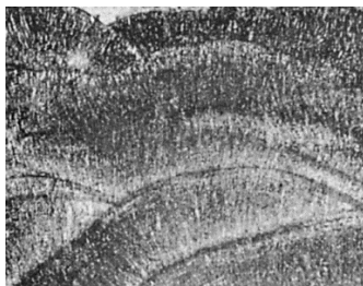
Рисунок 6.17 – Макроструктура многослойного сварного шва, \times 20
