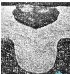
Рисунок 10.30 – Провисание шва x10
